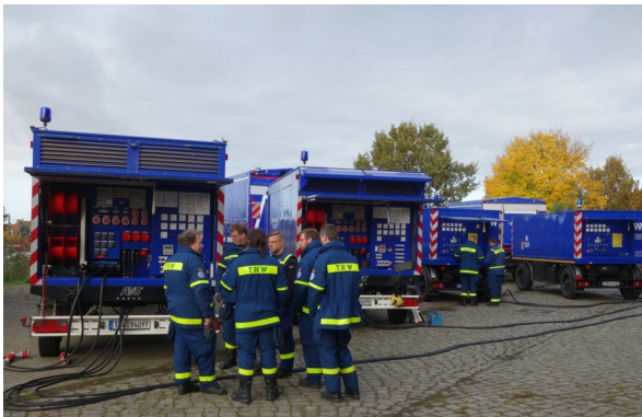
Gemeinsame Ausbildung der niedersächsischen Elektroversorgungsgruppen, nach langer Zeit wieder einmal in Lüneburg: Parallelbetrieb der Netzersatzanlagen (links) und Arbeiten an Freileitungen (rechts)
