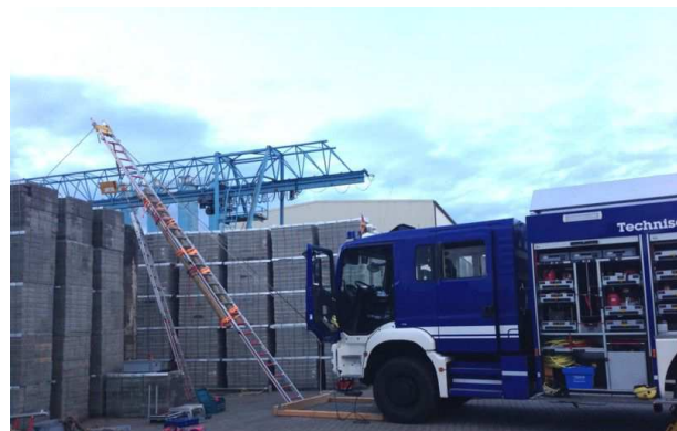
GKW mit vorgebautem Mastkran während der Übung im Betonwerk Neetze
