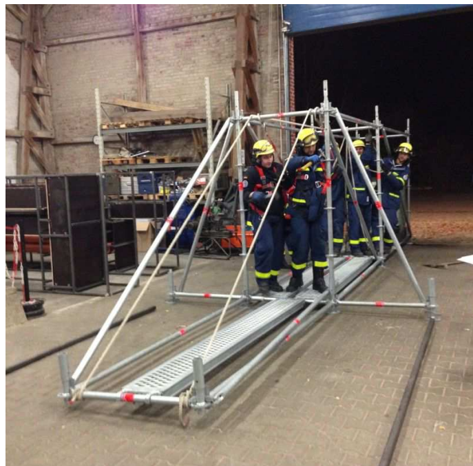
Multitool EGS – links z.B. zum seitlichen Abstützen eingesetzt, rechts als Behelfssteg aufgebaut
