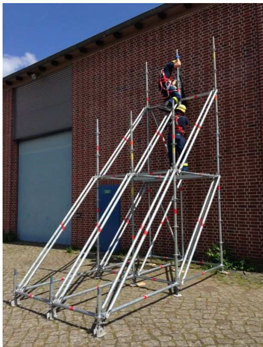
Multitool EGS – links z.B. zum seitlichen Abstützen eingesetzt, rechts als Behelfssteg aufgebaut
